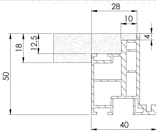
Wykończenie powierzchni ściany frezowaną płytą 18mm.
