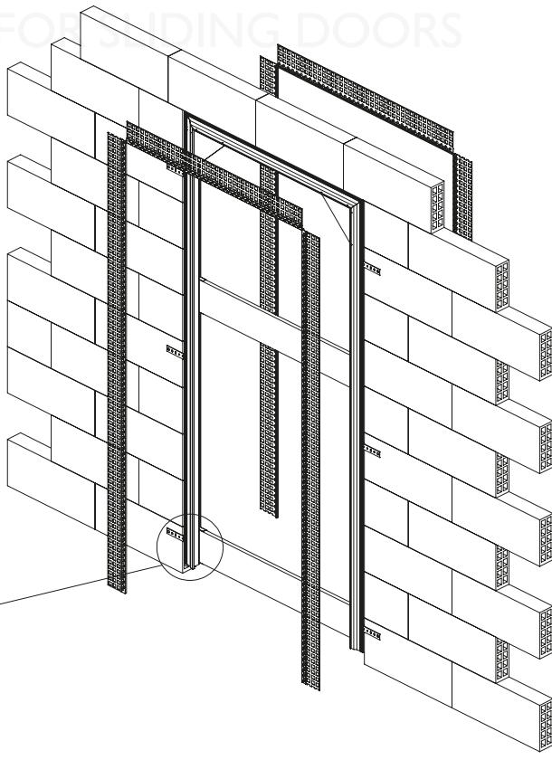
Przy tynkowaniu użyć siatki wzmacniającej na łączeniach.
