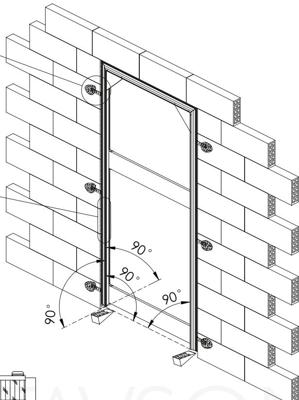
Wysokość ościeżnicy jest wymiarem do gotowej podłogi.
