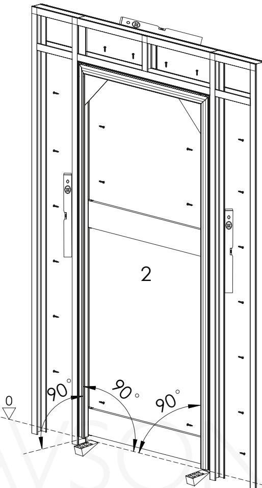
Wysokość ościeżnicy jest wymiarem do gotowej podłogi.
